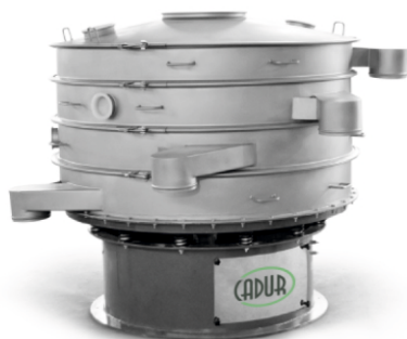
Рис. 1 Внешний вид вибросита
