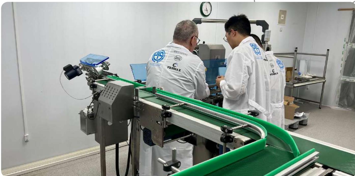
Машины оснащены встроенными системами автоматической остановки, которые активируются при возникновении нештатных ситуаций, таких как недостаточное давление сжатого воздуха, неправильная подача заготовки, инструкций или продукции.
